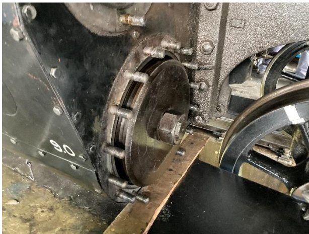
↑ピストン取外しの様子
