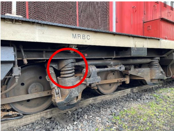
▲3軸台車の一部部品と車体(台枠)が接触している状態です。
